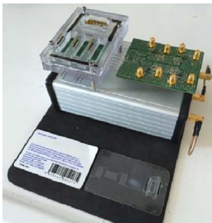
Συσκευή ανίχνευσης βακτηρίων σε τρόφιμα που αναπτύχθηκε στο πλαίσιο του ευρωπαϊκού προγράμματος LoveFood. Η πλαστική πλακέτα σε μέγεθος πιστωτικής κάρτας που φαίνεται κάτω δεξιά χρησιμοποιείται για τη φόρτωση και ανάλυση του δείγματος.
